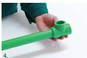
Nakon propisanog vremena zagrijavanja izvucite cijev i spojnicu iz matrica. Odmah ih bez okretanja gurnite jedno u drugo dok ne prekrijete označenu dubinu zavarivanja.
