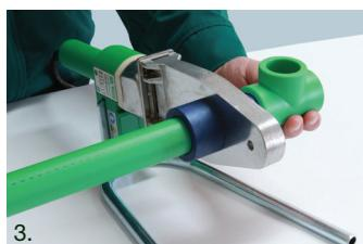
Postavite aparat za zavarivanje u nosač. Matrice učvrstite na aparat pomoću imbus ključa. Uključite aparat za zavarivanje (polifuzor) kako bi postigao radnu temperaturu. Odmjereni kraj cijevi bez okretanja gurnite u žensku matricu do označene dubine zavarivanja. Istovremeno gurajte i spojnicu na mušku matricu, također ravnomjerno i bez okretanja. Cijev se ne smije preduboko uvući u spojnicu, jer bi to moglo dovesti do začepljenja cijevi.
